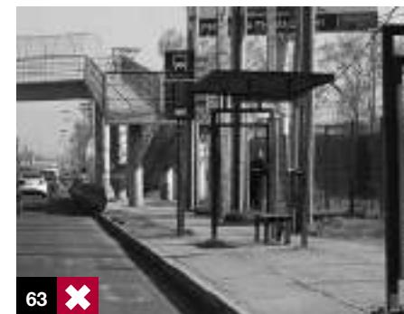
Foto 63: exceso de señales y elementos verticales obstaculizan circulación peatonal en la vereda. Santiago, Chile.
