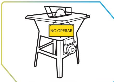
5. En caso de mantención, siempre utilizar medios de advertencia "No Operar - Equipo en Mantenimiento", si no es posible, solicitar ayuda para mantener resguardo de interruptores mientras dure la tarea.
